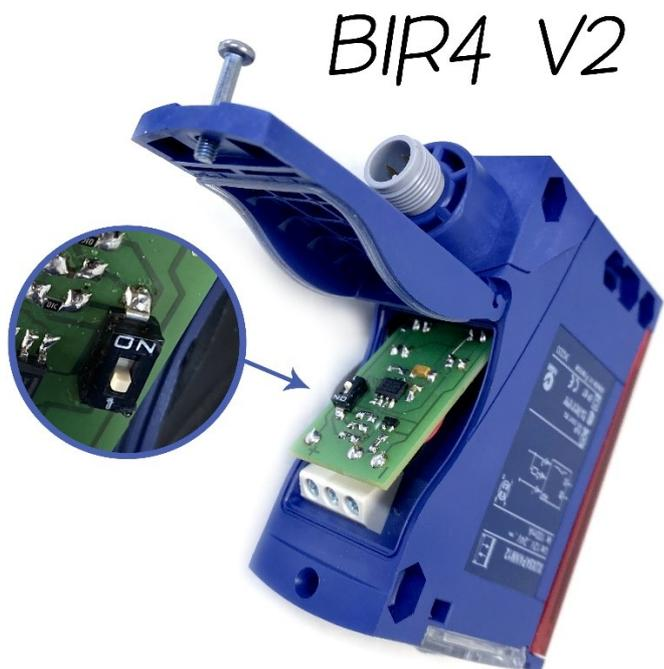
Un micro interrupteur ON/OFF permet maintenant de choisir entre un mode « **RAFALES** » (ON) (déclenchement continu tant que l'animal reste dans le faisceau de la barrière) ou un mode **classique** (OFF) (un seul déclenchement par coupure de faisceau)
