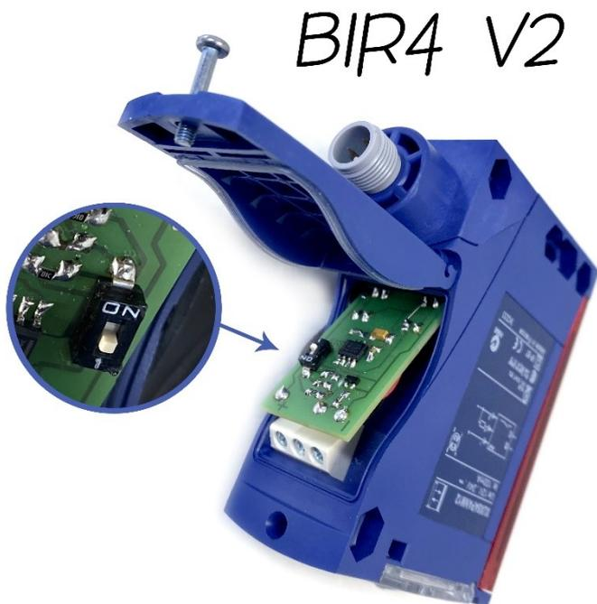
Un microinterruptor ON/OFF permite ahora elegir entre un modo "**RAFALES**" (disparo continuo mientras el animal permanezca en el haz de la barrera) o un modo **clásico** (OFF) (un único disparo por corte de haz)
