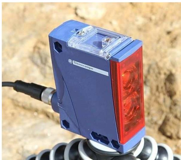
Esta unidad debe ser alimentada por una batería de 12V como mínimo. Conecte el cable al módulo, luego alimente el módulo con una batería de 12V, respetando las polaridades, terminal **rojo** = +, terminal **azul** o **negro** = -.
