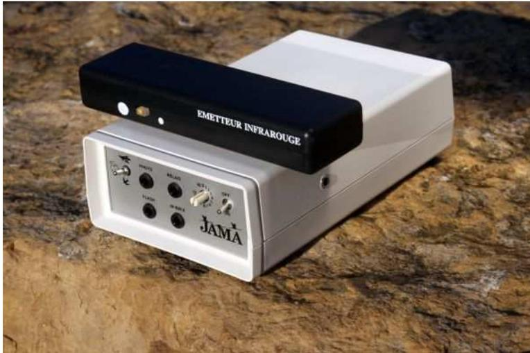
La barrière infrarouge va permettre de déclencher un appareil photo ou un flash de façon « intelligente » dès la coupure du rayon généré par l'émetteur infrarouge.
